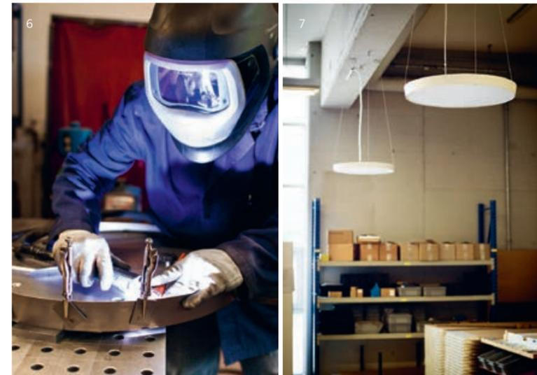
6 | Präzises Schweißen des Leuchtkörpers aus präzisen Blechteilen. 7 | An den Arbeitsplätzen in der Produktion wird unter den eigenen Leuchten gearbeitet. 8 + 10 | aus diesen Metallbändern entstehen die «Circular»-Leuchten, die es nun in 10 Farben gibt. 9 | Architekten schätzen die kürzlich aktualisierte Farbskala mit 10 Standardfarben.
